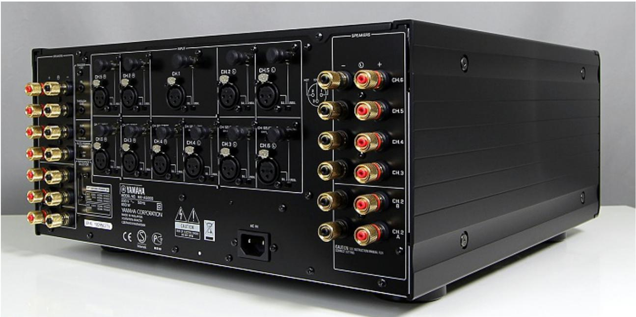
11-Kanal-Endstufe MX-A5000 von Yamaha (Rückseite)
