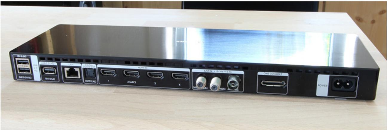
Die Samsung One Connect Box lagert die Anschlüsse in eine externe Box aus
