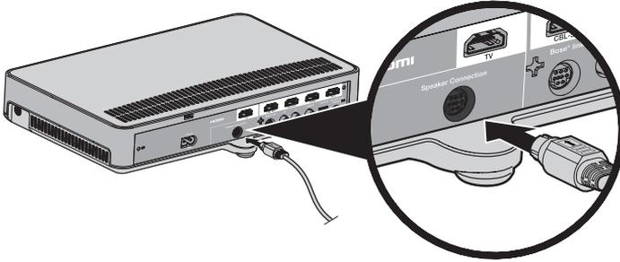
2. Schließen Sie den anderen Stecker des Lautsprecherkabels an den Anschluss **Audio IN** an der Soundbar an.
