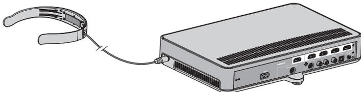
2. Schließen Sie das Kabel des ADAPTiQ-Headsets an den Anschluss
