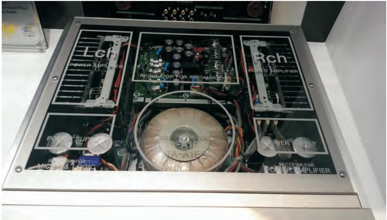
Der TA-A1ES brilliert mit hervorragendem inneren Aufbau
