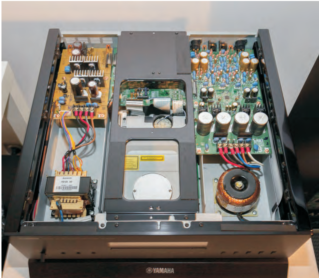
Konstruktion des CD-Players CD-S2100
