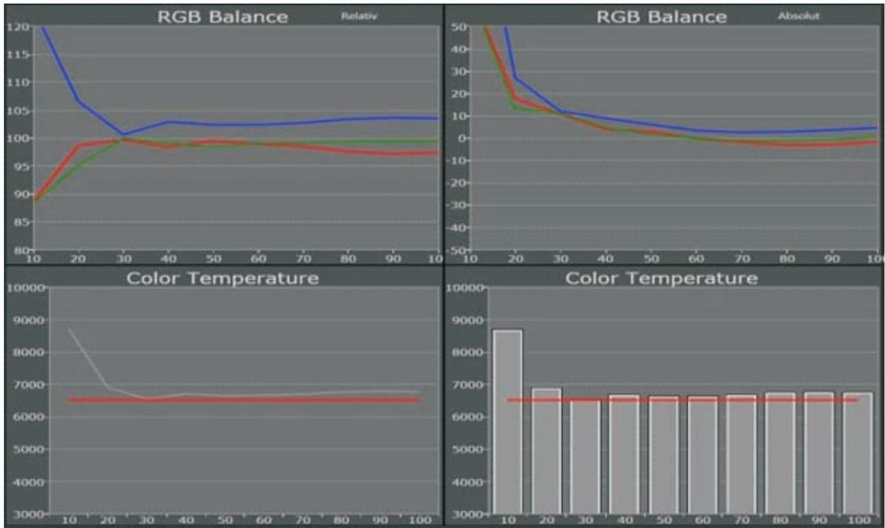
Gute RGB-Balance, korrekte Farbtemperatur bei jeder Bildhelligkeitsstufe.
