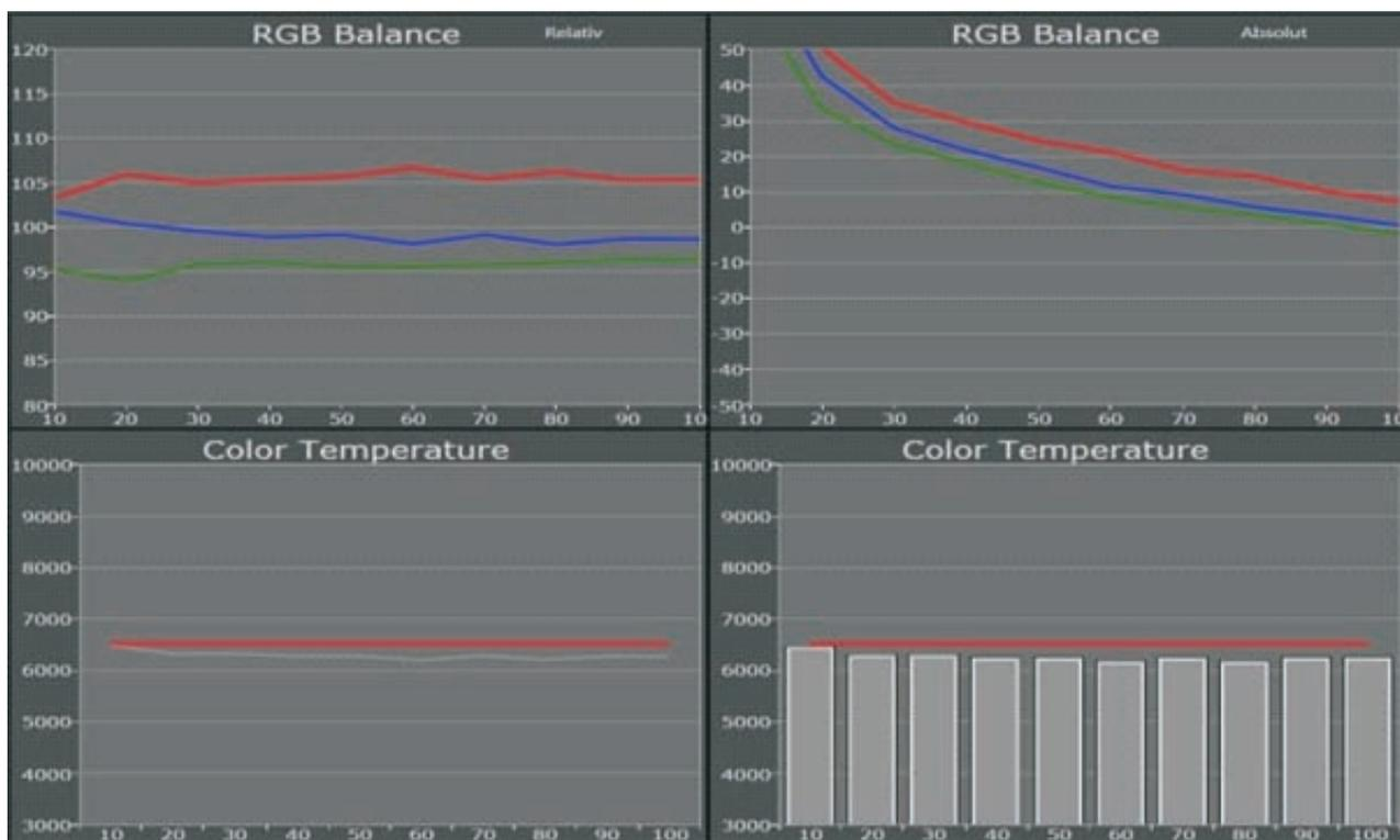
RGB-Balance sowie Farbtemperatur bei verschiedenen Bildhelligkeitsstufen
