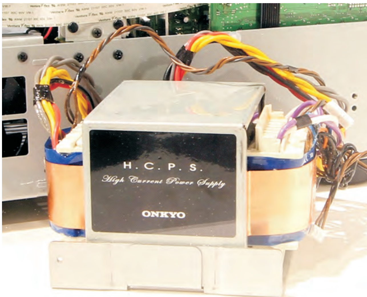
Leistungsstarker Trafo des TX-NR3030
