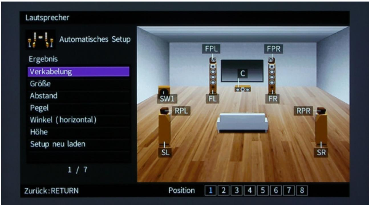
Lautsprecher-Setup inklusive Erkennung von Top-Firing Modulen
