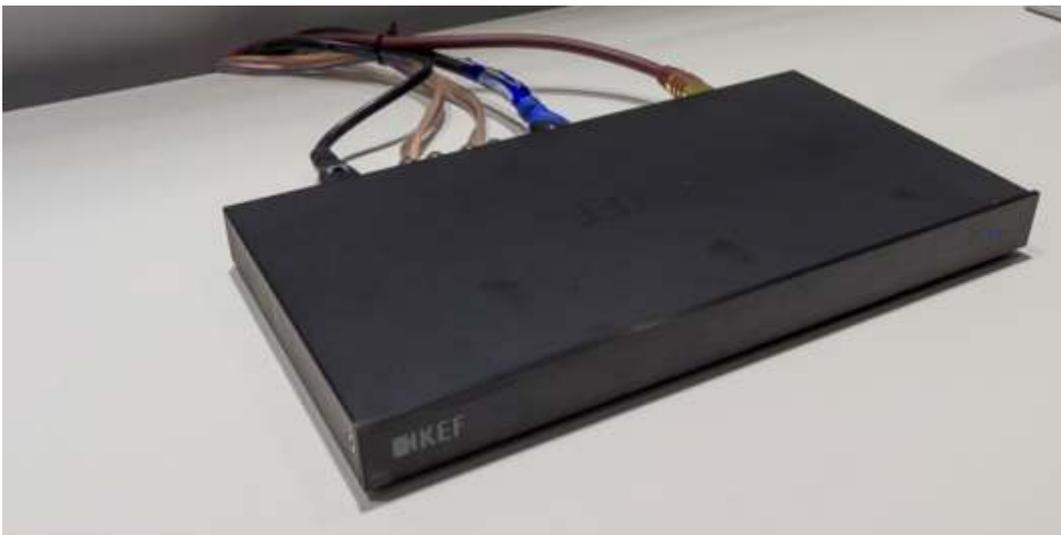
Box, in der die Verstärker- und Steuerungselektronik untergebracht ist
