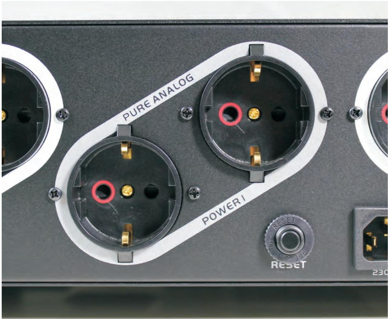
Analoge (ungefilterte) und auch digitale (gefilterte) Steckdosenplätze
