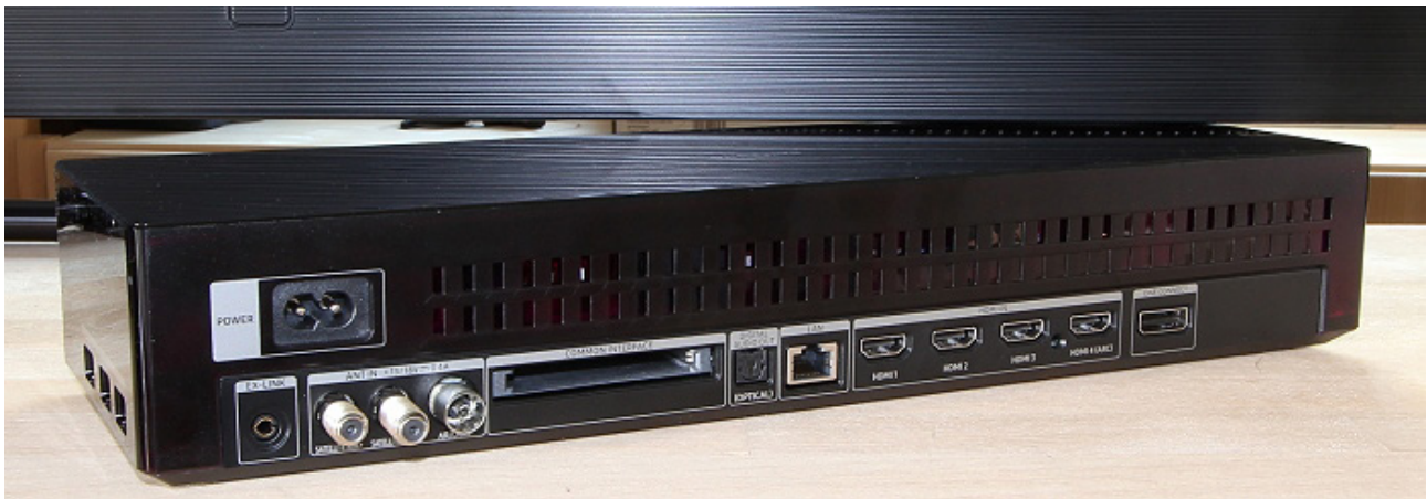
Samsung lagert die Anschluss-Sektion in die externe „One Connect Box“ aus
