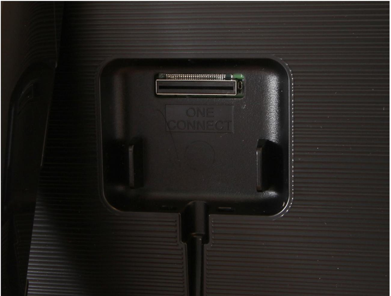
Anschluss der One Connect Box per One Invisible Cable am Q9FN
