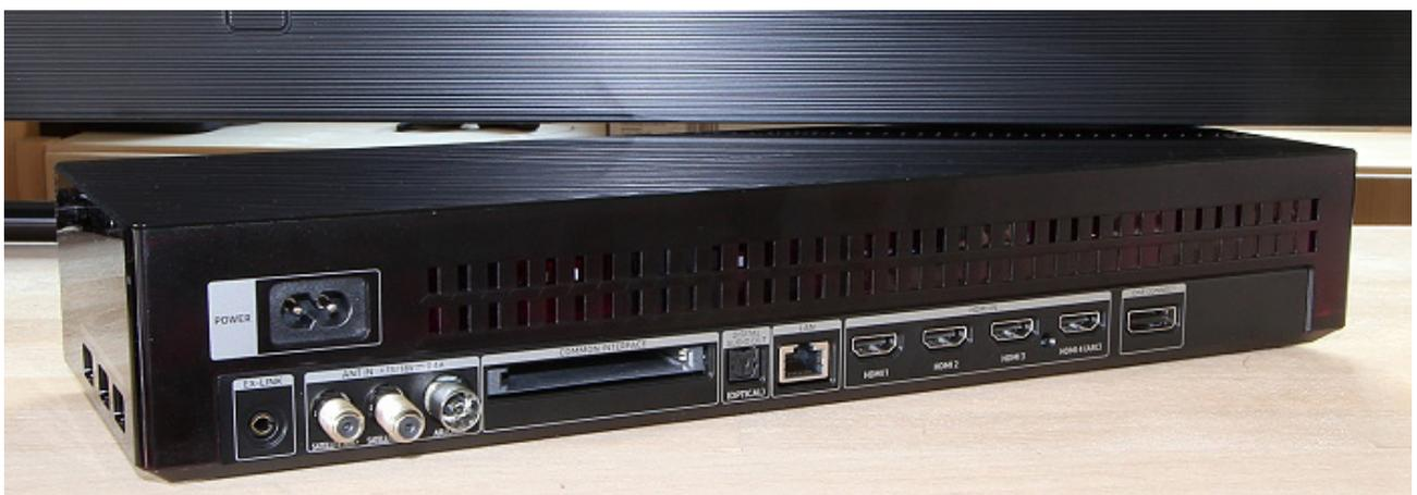
Die Anschlüsse sind in der One Connect Box ausgelagert
