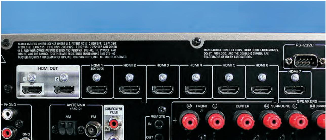
Yamaha RX-A820: hinten **sieben HDMI-Eingänge** und **zwei HDMI-Ausgänge**
