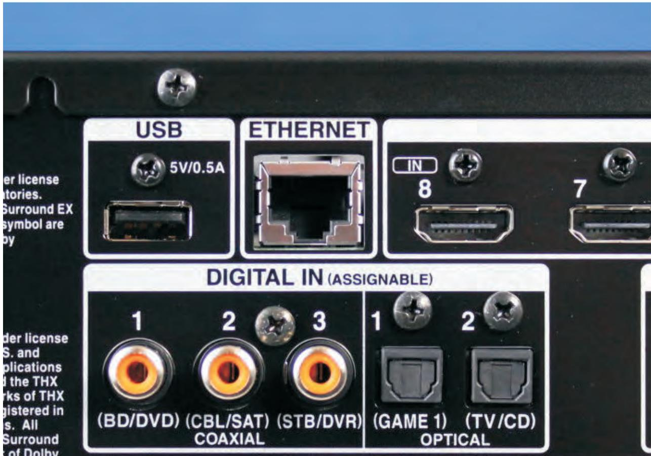
Die Ethernet-Schnittstelle ist für die **kabelbasierte Einbindung** des AV-Receiver ins Heimnetzwerk zuständig.
