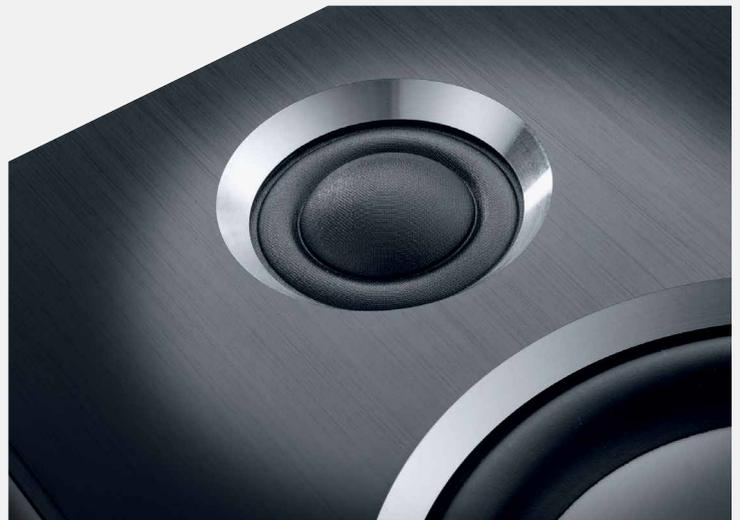
Edelstein ein Edelstein: Ein Kapton-Schwingspulenträger treibt in der Tiefe eine Sandwich – Membran aus Aluminiumoxid-Keramik an. Ab 2500 Hertz werden die Impulse weitergereicht an eine Seidenkalotte, die Magnat formschön – und effektiv als Schallführung – hinter eine konisch gefräste Frontblende gelegt hat.
