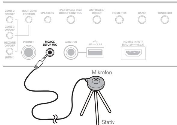
Wenn ein Stativ zur Verfügung steht, stellen Sie das Mikrofon bitte in der Höhe auf, die Ihrer Hörposition entspricht. Wenn Sie kein Stativ haben, verwenden Sie einen anderen Gegenstand zum Anbringen des Mikrofons.
