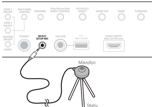
Stellen Sie sicher, dass sich keine Hindernisse zwischen den Lautsprechern und dem Mikrofon befinden. Wenn ein Stativ zur Verfügung steht, stellen Sie das Mikrofon bitte in der Höhe auf, die Ihrer Hörposition entspricht. Wenn Sie kein Stativ haben, verwenden Sie einen anderen Gegenstand zum Anbringen des Mikrofons. Stellen Sie das Mikrofon auf stabilem Untergrund auf. Wenn Sie das Mikrofon auf eine der folgenden Oberflächen stellen, sind präzise Messungen nicht möglich:
