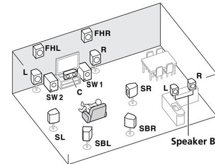
Mit diesen Verbindungen können Sie gleichzeitig 7.2-Kanal-Surroundklang in der Hauptzone mit Stereo-Wiedergabe des gleichen Klangs auf den B-Lautsprechern genießen. Dieselben Verbindungen ermöglichen auch die Ausgabe von 9.2-Kanal-Surroundklang in der Hauptzone, wenn Sie die Lautsprecher B nicht verwenden. Die Lautsprecher, von denen Ton ausgegeben wird, können mit der Taste **SPEAKERS** umgeschaltet werden. Einzelheiten siehe [Umschalten der Lautsprecheranschlüsse](#) auf [Seite 79](#).
