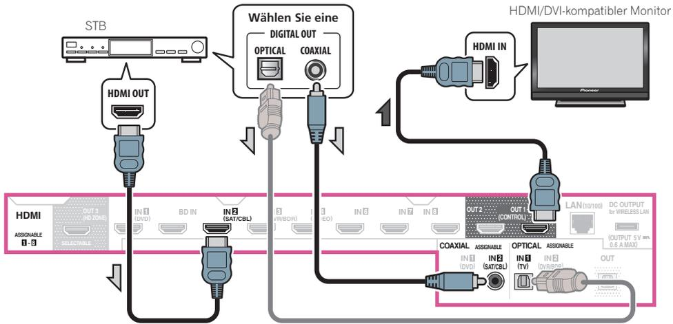
— Wenn Sie ein Digital-Audiokabel oder RCA (analoges) Audiokabel verwenden, müssen Sie dem Receiver mitteilen, an welchem Digitaleingang Sie die Set-Top-Box angeschlossen haben (siehe [Das Input Setup-Menü](#) auf [Seite 46](#)).
