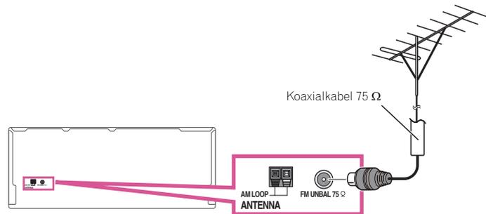
Schließen Sie zur Verbesserung des MW-Empfangs ein etwa 5 m bis 6 m langes, mit Vinyl beschichtetes Kabel an die **AM LOOP**-Anschlüsse an, ohne die mitgelieferte MW-Rahmenantenne zu entfernen. Der optimale Empfang ergibt sich bei einer horizontalen Aufhängung im Freien.
