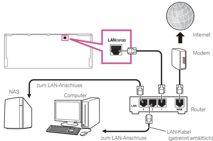
Verbinden Sie den LAN-Anschluss an diesem Receiver mit dem LAN-Anschluss an Ihrem Router (mit oder ohne eingebaute DHCP-Server-Funktion) mit einem direkten LAN-Kabel (CAT 5 oder höher).
