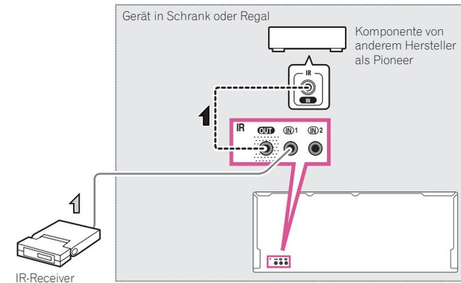
**2 Verbinden Sie die Buchse IR IN einer anderen Komponente mit der Buchse IR OUT auf der Rückseite dieses Receivers, um diese mit dem IR-Receiver zu verbinden.**
