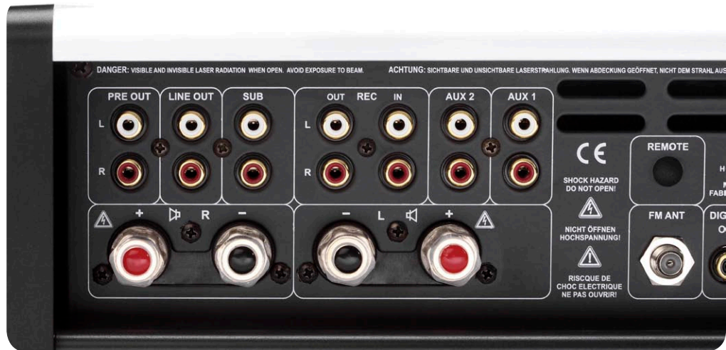
An den links sichtbaren Vorverstärker-Ausgang können auch Aktiv-Lautsprecher angeschlossen werden
