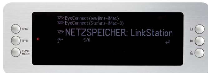
Im Streaming Client-Modus zeigt der Music Receiver die verfügbaren NAS an, hier unsere Buffalo LinkStation, um den gewünschten Server beziehungsweise die Musikquelle auszuwählen
