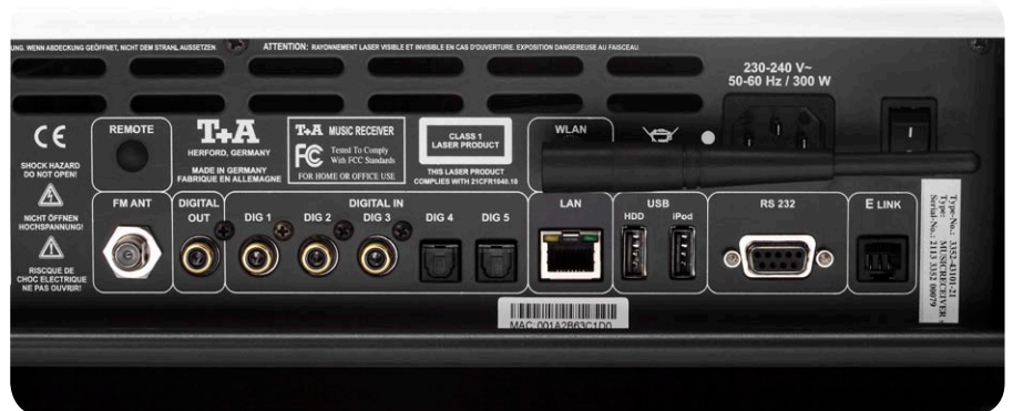
Dank zweier USB-Schnittstellen kann eine Festplatte und ein iPod parallel an den Music Receiver angeschlossen werden
