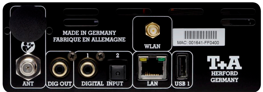
Dank seiner zwei Digitaleingänge kann der MP 1260 R anderen Digitalquellen als hochwertiger externer Wandler dienen
