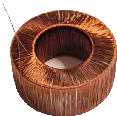
Die in den Verstärkern der Serie 14 eingesetzten Ringkerntransformatoren werden von Rotel hergestellt.
