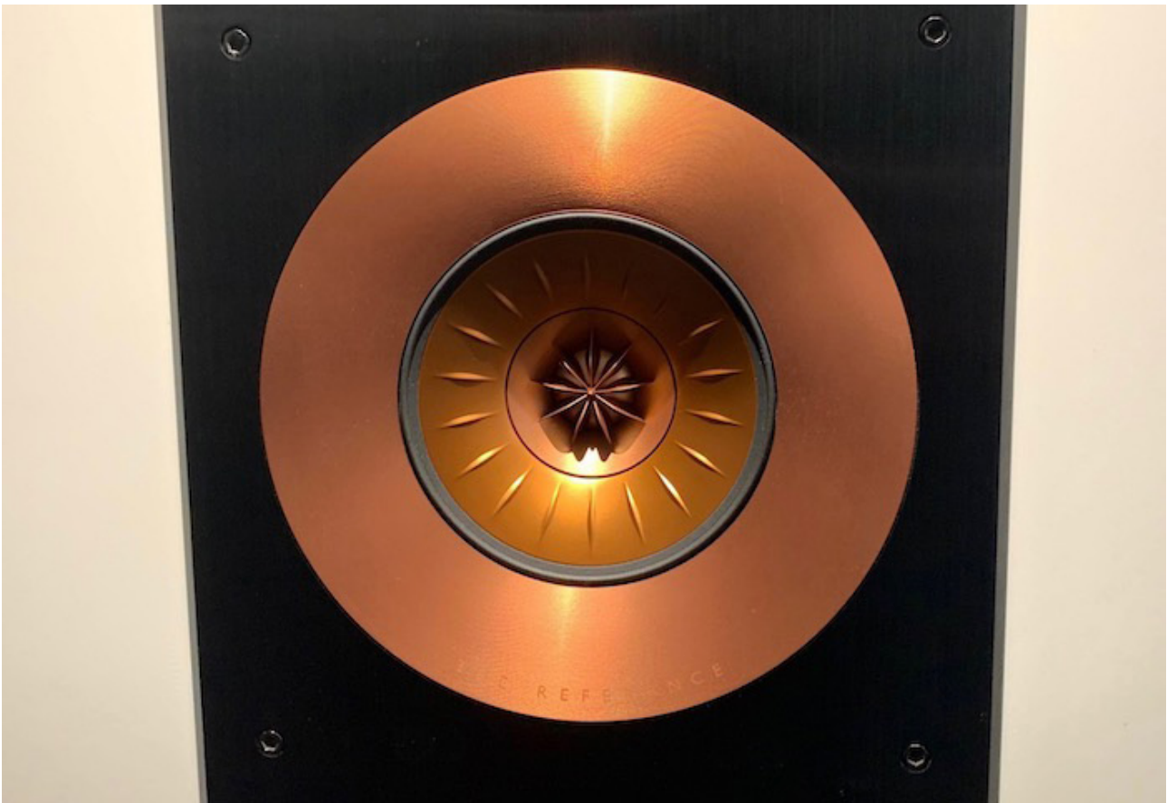
Zentrales Element: Uni-Q Koaxial-Treiber
