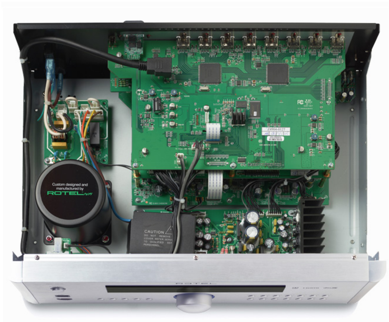
Innerer Aufbau, links der typische Ringkern-Transformator
