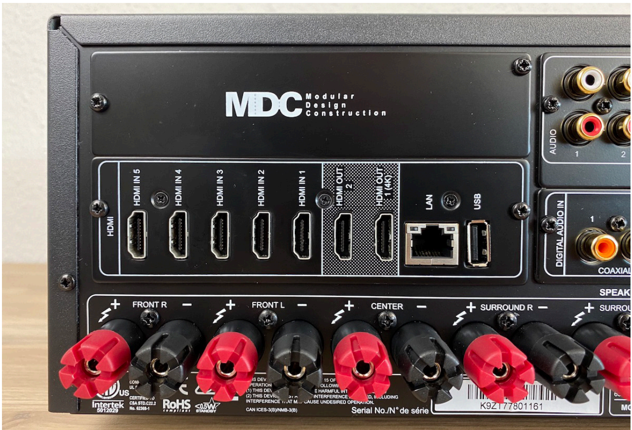
Klares Kennzeichen der NAD-Komponenten: der modulare Aufbau
