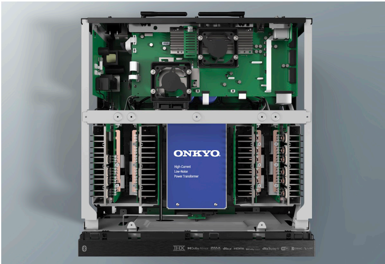
Innenansicht des Mehrkanal-Receiver
