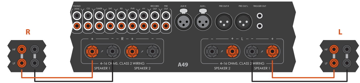
Un A49 collegato agli altoparlanti con cablaggio singolo.
