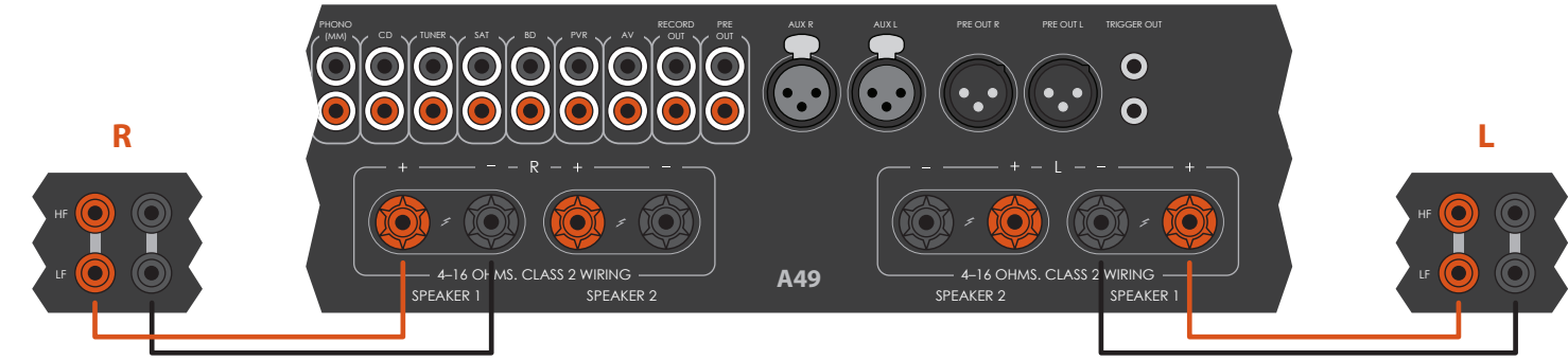
使用单线分音方式连接至扬声器的A49。
