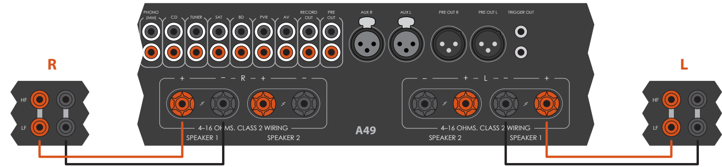
Усилитель A49 подключен к колонкам однопроводным соединением.
