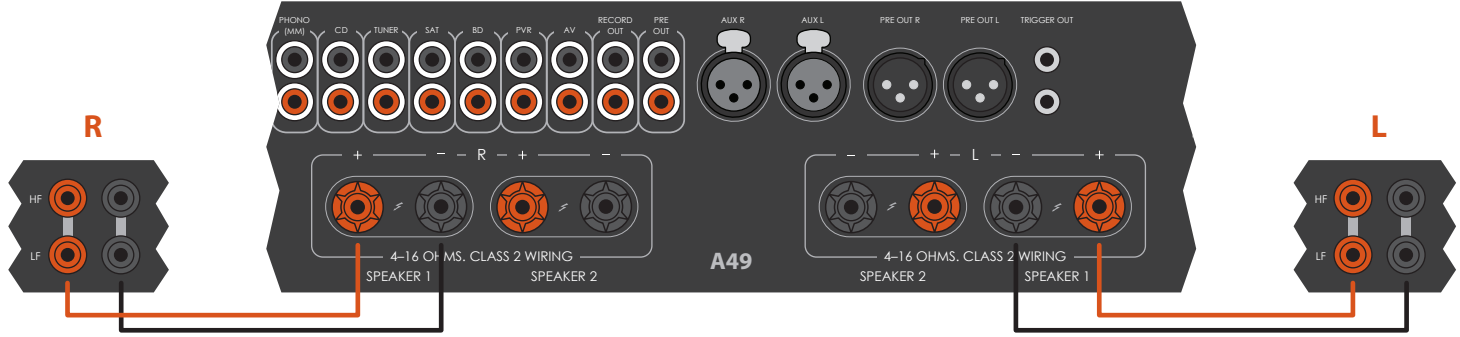
Der A49 mit Einzelverdrahtung der Lautsprecher.
