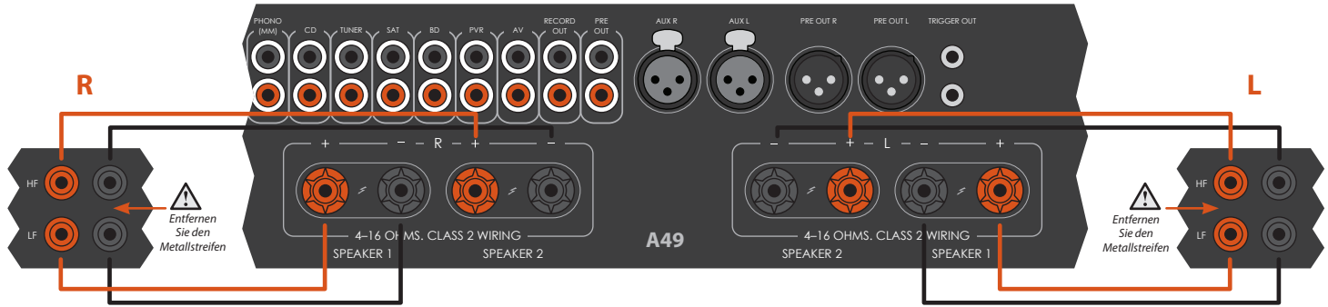
Der A49 mit Doppelverdrahtung von zwei Lautsprechergruppen.
