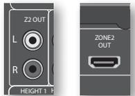
Der HDMI-Anschluss Z2 Out dient zum Anschluss des Ausgangs des AVR an ein System in einem zweiten Raum.
