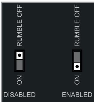
Dieser Filter beseitigt das niederfrequente „Rumpeln“, das in der Regel durch Unvollkommenheiten der Schallplatte (z. B. Unregelmäßigkeiten beim Pressen oder verzogene Schallplatten) verursacht wird und die Leistung der rPhono beeinträchtigen kann.
