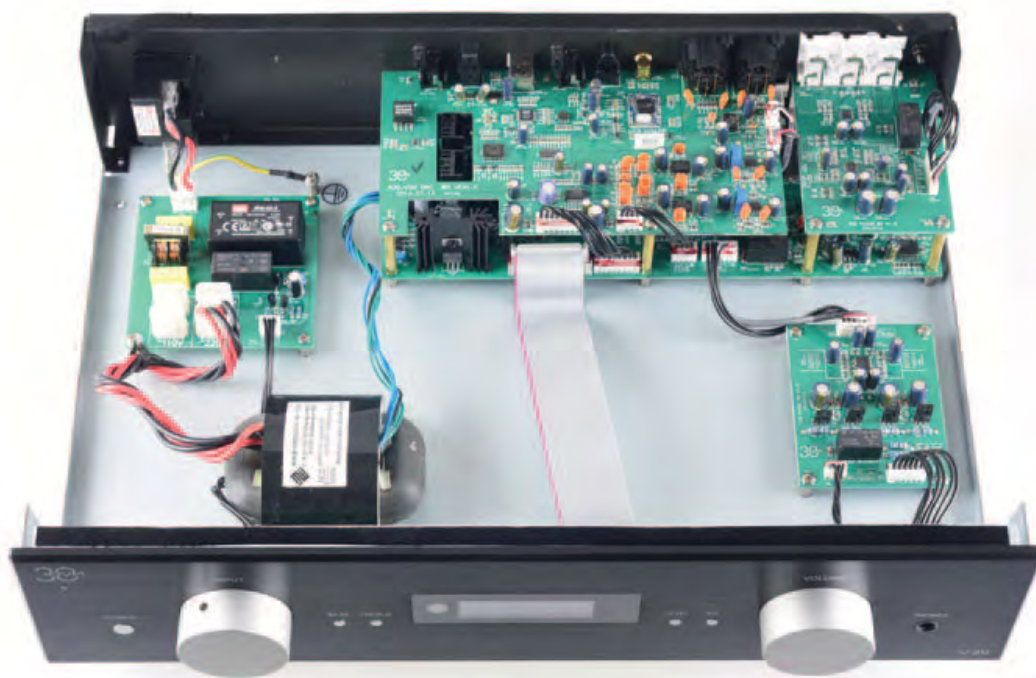
Durch ihre geringe Ausgangsimpedanz kann die V30-Vorstufe auch längere Leitungen zu den Endstufen locker treiben. Dennoch bleibt zu überlegen, die Monos trotzdem zum Vorverstärker zu stellen: Lange NF-Leitungen sind viel empfindlicher als lange Lautsprecherkabel.
