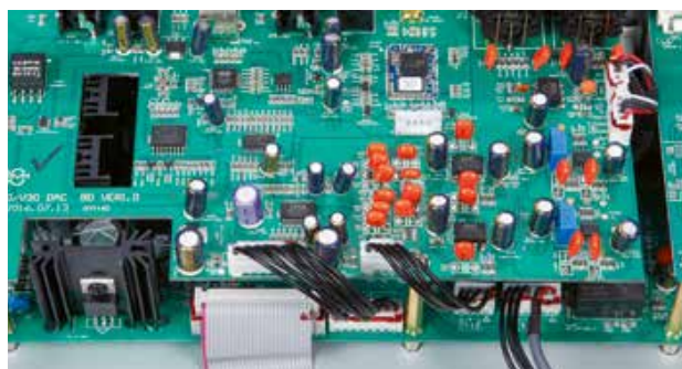
▲ Die AVM-Geräte überzeugen durch einen blitzsauberen und durchdachten Aufbau. Phonoplatine und Trafo liegen weit auseinander.
