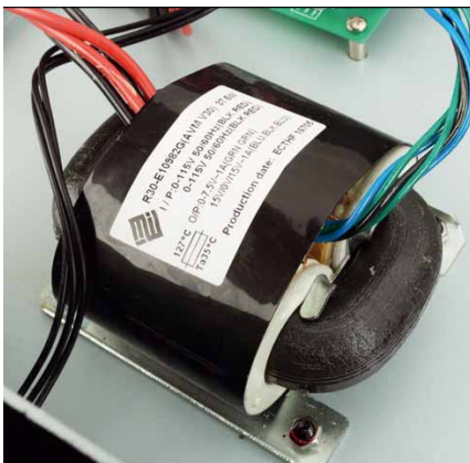
Edel: Ein R-Core-Trafo versorgt die Vorstufe
