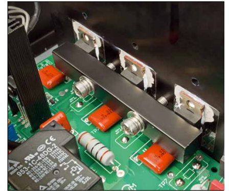
Massive Metallstäbe pressen die Endtransistoren gegen ihre Kühlkörper
