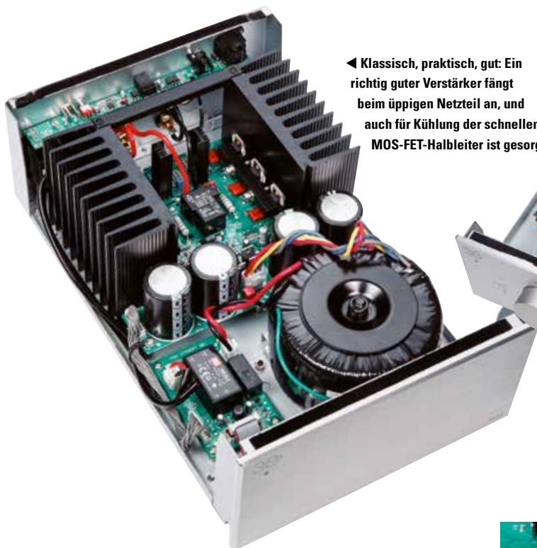
▲ Die AVM-Geräte überzeugen durch einen blitzsauberen und durchdachten Aufbau. Phonoplatine und Trafo liegen weit auseinander.
