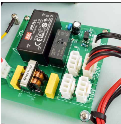
Ein kleines Schaltnetzteil versorgt die Digitalbaugruppen beider Geräte
