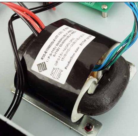
Edel: Ein R-Core-Trafo versorgt die Vorstufe
