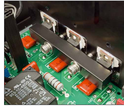
Massive Metallstäbe pressen die Endtransistoren gegen ihre Kühlkörper
