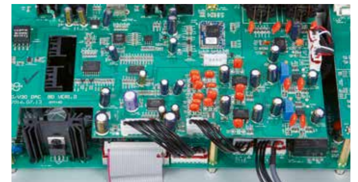
In der AVM-Vorstufe geht es mehrlagig zu. So sind Analog- und Digitalsektion strikt getrennt. ▶
