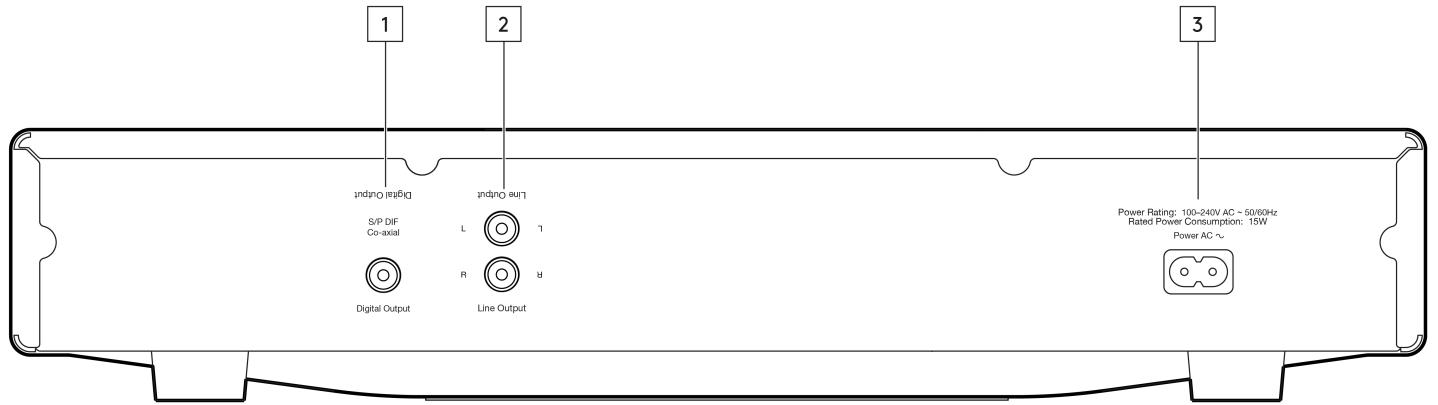
**1. KOAXIALER S/PDIF-DIGITALAUSGANG (NUR AXC35)** – Für die Ausgabe an einen separaten D/A-Wandler oder ein digitales Aufnahmegerät. Um die besten Ergebnisse zu erzielen, verwenden Sie ein hochwertiges 75-Ohm-Digital-Cinchkabel (nicht eines, das für den normalen Audiogebräuch ausgelegt ist).
