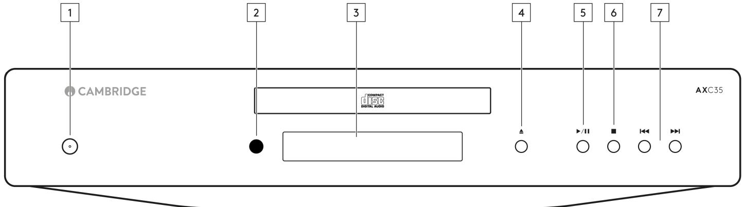
**1. Netzschalter** – Schaltet das Gerät zwischen dem Standby-Modus (angezeigt durch abgedunkelte Power-LED) und Ein (angezeigt durch hell leuchtende Power-LED) um. Der Standby-Modus ist ein Energiesparmodus, bei dem der Stromverbrauch weniger als 0,5 Watt beträgt. Bei diesem Produkt ist die automatische Abschaltfunktion (Auto Power Down, APD) standardmäßig aktiviert. Nach einer Inaktivität von 20 Minuten geht das Produkt automatisch in den Standby-Modus über.
