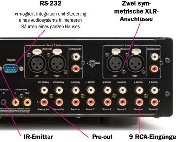
Bei Anordnung in einem Schrank einfach einen IR-Emitter (Infrarot) anschließen, um das Gerät ganz steuern zu können, ohne es zu sehen" Zum Anschluss eines Subwoofers oder Leistungsverstärkers
