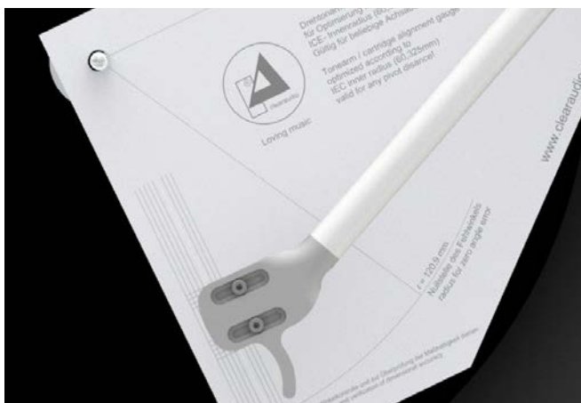
Abb. 10: Parallelität des Tonarmes
