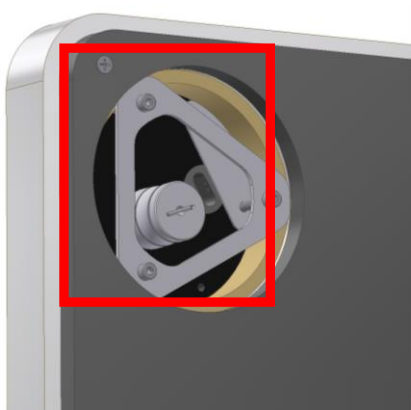
Abb. 9: Einstellung des Antiskating
