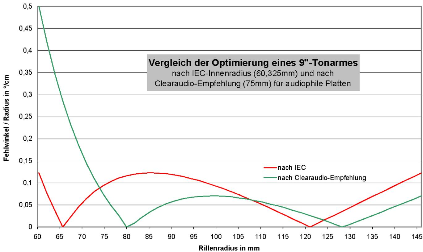
Daten: Die Überhangeinstellung ist absolut korrekt für beliebige Achsabstände.
