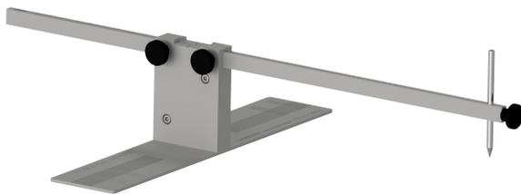
Zunächst entscheidet man sich für die Optimierung des bespielten Rillinnenradius nach IEC-Norm ( $r=60,325$ ) oder nach einer der **clearaudio** Empfehlungen ( $r=65$ ,  $r=70$ ,  $r=75\text{mm}$ ) und stecke den Peilarm so, dass er (mit dem Dorn) nach rechts und die Markierung für die gewünschte Optimierung zum Anwender zeigt.
