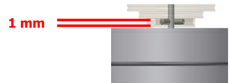
Abb. 12: Befestigen des Antriebsrades
