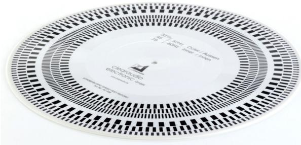
Zur Einstellung der exakten Geschwindigkeit wählen Sie bitte zunächst die richtige Plattenseite. Die Seite mit den breiten Strichen (siehe Bild) eignet sich zur Drehzahlregulierung mit jeder herkömmlichen Lichtquelle. Hier ist es möglich auch bei unterschiedlichen Netzspannungen von 50 Hz (Europa) mit Hilfe der äußeren Skala, oder bei einer Netzspannung von 60 Hz (USA) die Ge-
