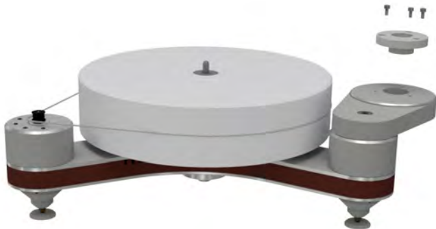
Abb. 2: Montage des Klemmrings
