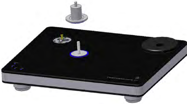
Abb. 6: Aufsetzen des Lageroberteils
