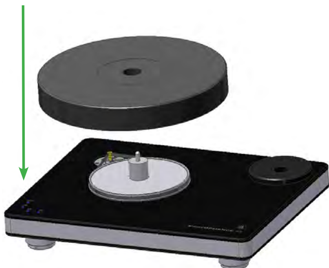
Abb. 8: Aufsetzen des Plattentellers auf das Lager
