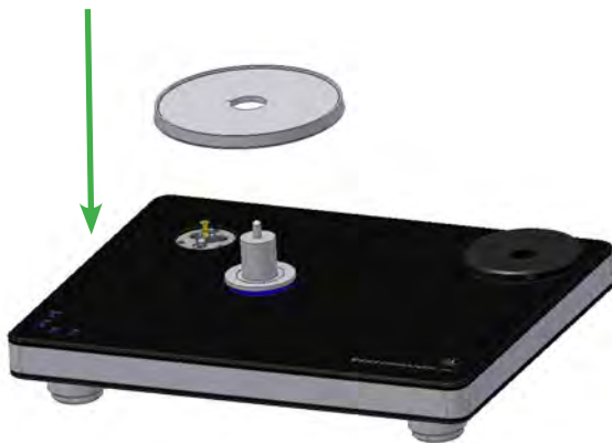
Abb. 7: Aufsetzen des Sub-Tellers
