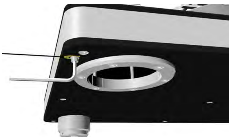
Abb. 4: Erden des Performance DC Laufwerks
