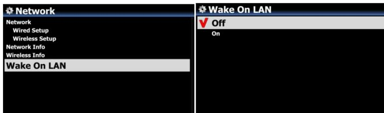
Wenn bei "Wake ON LAN" AN eingestellt ist, kann der X50 durch ein Signal von außen via Netzwerk eingeschaltet werden.
