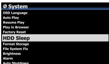
※ Der X50 benötigt ca. 3-4 Sekunden, um aus dem Ruhemodus zu "erwachen". Während dieser Zeit spricht der X50 mit Verzögerung auf Befehle der Fernbedienung an.
