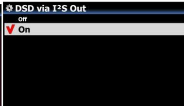
Wenn AN eingestellt ist, gibt der X50 natives DSD-Signal über den I²S Ausgang aus. Im Modus AUS wandelt der X50 per Hardware das DSD-Signal in PCM um.
