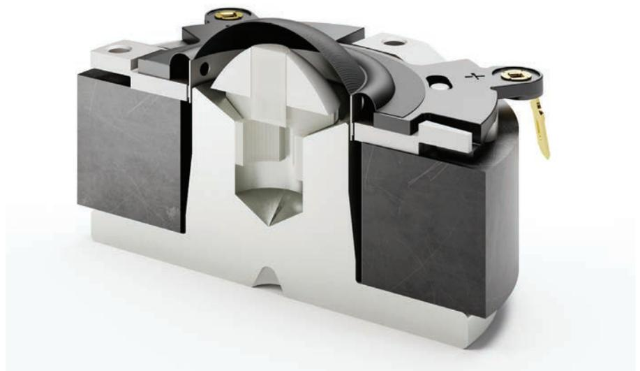
*Der Kalottenhochtoner besteht aus einer extrem leichten Kalottenmembran, einem großen Ferritmagneten und einer von ultradünnem magnetischen Fluid gekühlten Schwingspule.*
