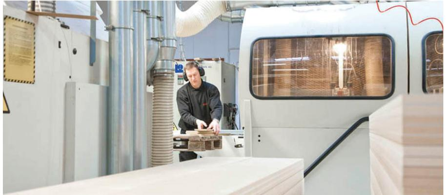
*Zuschnitt der MDF-Platten für die OPTICON-Gehäusefertigung.*
