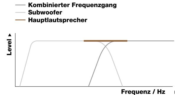
**Übergangsfrequenz korrekt eingestellt**
