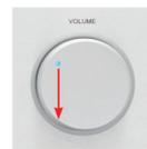
1. Bitte stellen Sie den Lautstärkeregler auf Minimum, bevor Sie ein Kabel anschließen oder abtrennen.
