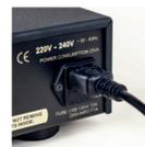
2. Schließen Sie das Netzkabel an die IEC-Netzeingangsbuchse an.
