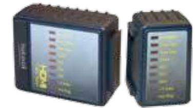
Der Exzellenz HDMI-Kabeltester (HDMI = High Definition Multimedia Interface) wurde entwickelt, um die Pin-Anschlüsse von HDMI-Kabeln zu prüfen und ggf. Fehler zu beheben. Er eignet sich hervorragend zum Überprüfen des Durchgangs der einzelnen Adern eines HDMI-Kabels, bevor dieses an Geräten angeschlossen wird.
