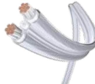
Hochflexible Litzen besitzen im Vergleich zu massiven Aufbauten in der Summe eine größere Leiteroberfläche. Dies kommt der Übertragung des Hochtonbereichs zu Gute. Neben dem feinen Litzenaufbau (0,07mm) unterstützt die Versilberung des Exzellenz Silver die Übertragung der Höhen. Die verlustarme PE-Aderisolation und das zusätzliche PE-Dielektrikum entlasten darüber hinaus den Verstärker. Für mehr Dynamik und Spielfreude.
