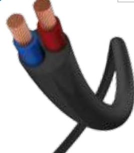
Spezielles halogenfreies und flammwidriges Lautsprecherkabel für den Installationsbereich. Das strapazierfähige Kabel ist dank des runden Aufbaus sehr verlegfreundlich. Die Litzen aus 0,25mm dicken Drähten sind leicht zu verarbeiten und sorgen für klangstarke Ergebnisse.
