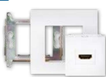
Der Tragering bildet die Grundlage für alle Premium AV-Blenden. Er wird mit der Installationsdose verschraubt und kann durch seine Langlöcher bequem ausgerichtet werden. Im Gegensatz zu dem Tragering für das AmbienTrack System #0098000 wird bei der neuen Version der Rahmen des verwendeten Schalterprogramms mit dem Verschrauben der Blenden fixiert. Mit Ausnahme der Version mit 3 RCA Buchsen passen alle bisherigen AV-Blenden.
