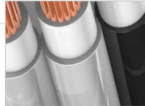
Luft ist theoretisch der beste, Polyethylen praktisch ein ausgezeichneter Isolator. Für viele Referenz Selection-Kabel hat in-akustik eine Isolation entwickelt, die aus zwei PE-Schichten besteht. Die erste Schicht ist mit Luft aufgeschäumt. Darüber liegt der zweite, massive PE-Mantel. Diese DUO-PE II Isolation verhindert hohe Kapazitäten und erleichtert die Arbeit für die Elektronik.
