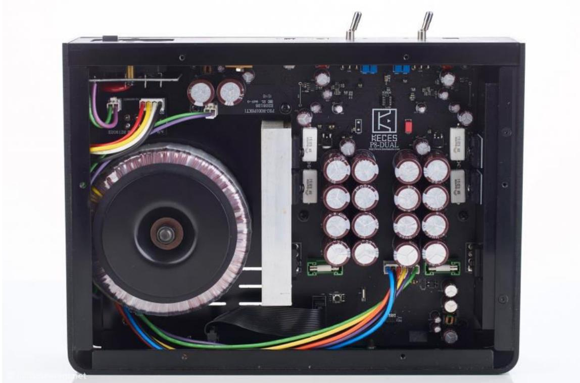
Das innere des P8 wird von einem großen Ringkerntransformator dominiert. Auf den Kühlkörpern rechts und links der Kondensatorbänke sitzen die Spannungsregler
