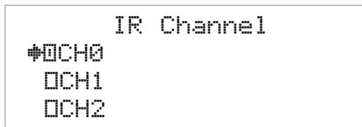
Der C 390DD kann über vier IR-Kanaleinstellungen betrieben werden. Dies ist praktisch nützlich, wenn Sie mehrere NAD-Produkte haben, die durch ähnliche Fernbedienungsbefehle bedient werden können. Mit den unterschiedlichen IR-Kanaleinstellungen können verschiedene NAD-Produkte unabhängig voneinander in derselben Zone gesteuert werden, indem jedes Produkt auf einen anderen IR-Kanal eingestellt wird.
