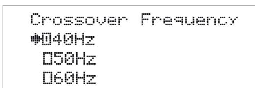
Frequenzen von 40 Hz bis 200 Hz können ausgewählt werden, wobei das Hochpass-Signal an den C 390DD-Verstärkerbereich und das Tiefpass-Signal an den Subwoofer-Ausgang gesendet wird.
