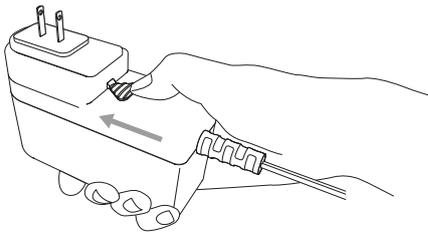
Drücken Sie zum Auseinanderbauen den Riegel nach außen, um den Stecker zu entfernen oder auszutauschen.
