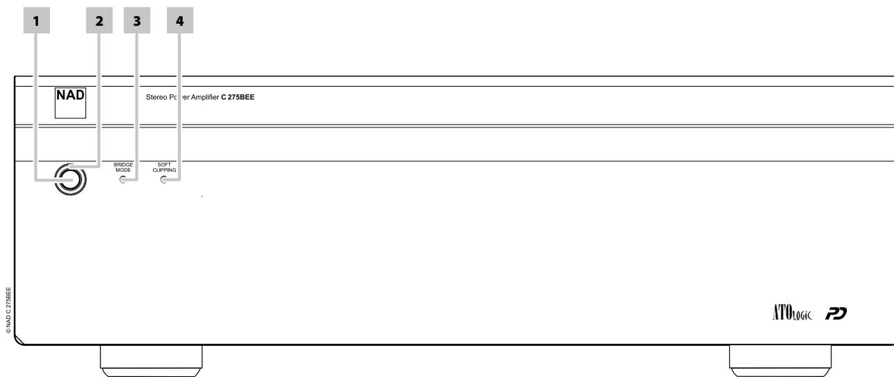
**1 SCHALTER STANDBY (BEREITSCHAFT):** Drücken Sie diese Taste, um den C 275BEE einzuschalten. Die LED für die Bereitschaftsanzeige schaltet von gelb auf blau um. Durch erneutes Drücken des SCHALTER STANDBY wird das Gerät wieder in den Bereitschaftsmodus versetzt.
