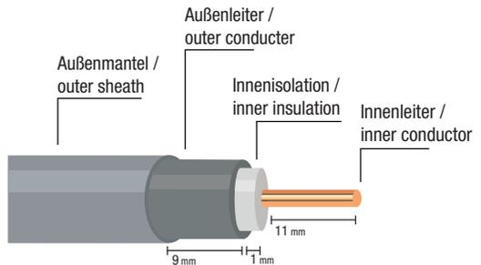
**DE** Die Antennensteckerhülse an das Kabel anschrauben.
