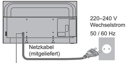
Schieben Sie den Netzstecker bis zum Anschlag ein.
