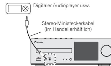
Wenn die Ministeckerbuchse **AUDIO IN** an die Nebenkopfhörerbuchse angeschlossen ist, wird die Lautstärke des Receivers durch die Lautstärke auf dem Wiedergabegerät eingestellt. Wenn der Klang verzerrt ist, nachdem Sie die Lautstärke des Receivers herabgesetzt haben, versuchen Sie, die Lautstärke auf dem Zusatz-Wiedergabegerät herabzusetzen.
